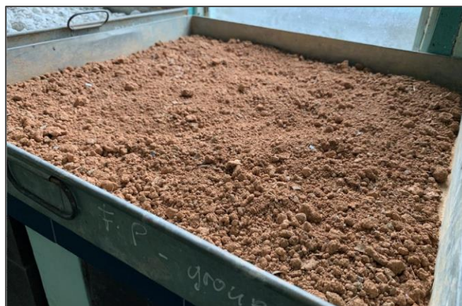
Rajah 3. Sampel tanah yang diperolehi dari runtuh cerun Taman Bandar Kuantan, Pahang.
